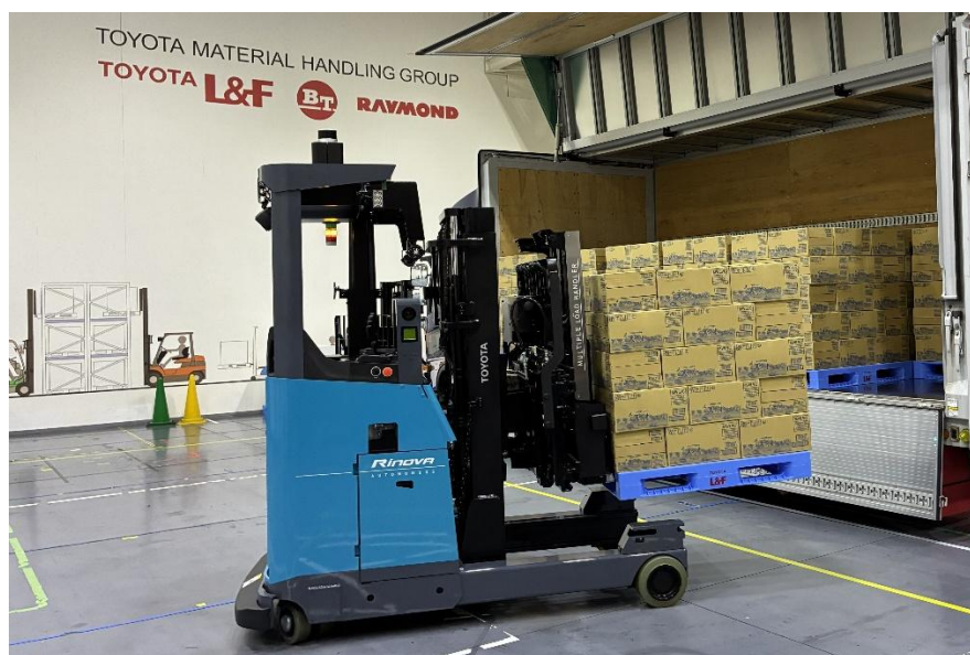
【トラック荷役対応自動運転フォークリフト（マルチロードハンドラー仕様）】
